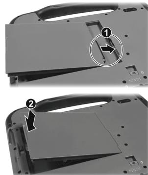
3. Stellen Sie sicher, dass der Akkriegel richtig eingerastet ist; der darunter befindliche rote Teil darf nicht herausragen.
