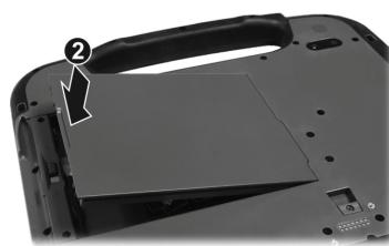
3. Фиксатор аккумулятора при этом не должен открывать красную метку.
